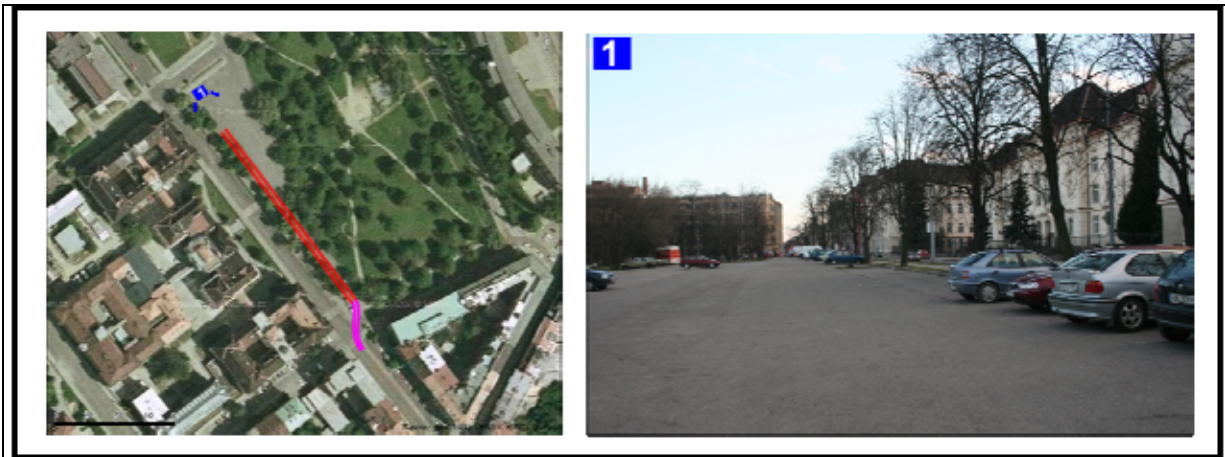
Abbildung 158: Status quo und mögliche Lage von Abstellgleisen im Björnsův Sad. Mit lila Farbe sind erforderliche neue Gleise gekennzeichnet, mit roter Farbe die benötigte Fläche zum Abstellen zweier 70m langer Stadtregionalbahngarnituren, mit dem blauen Kamerasymbol die Perspektive des Fotos. Kartengrundlage des Orthofotos: www.mapy.cz , ansonsten eigenes Foto vom Februar 2007. Übersichtsplan aller Infrastrukturmaßnahmen für die Stadtregionalbahn siehe Abbildung 157.
