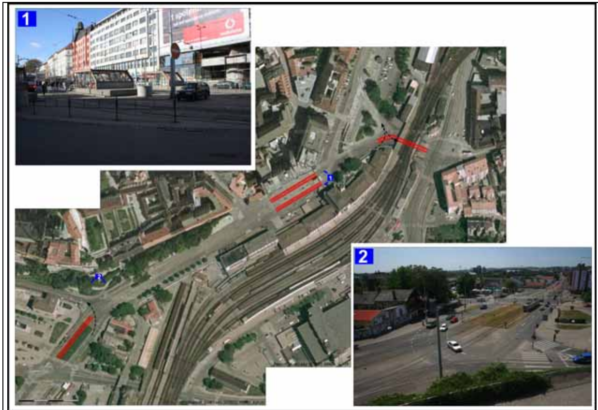
Abbildung 161: Situation bei den Haltestellen vor dem Hauptbahnhof und an den benachbarten Kreuzungen. Mit roter Farbe ist die Fläche gekennzeichnet, die erforderlich ist um eine 70m lange Stadtrahngarnitur abzustellen, mit den blauen Kamerasymbolen mit Zahl die Perspektiven der Fotos. Die schwarzen Pfeile zeigen gegebenenfalls durch die Stadtrahngarnitur behinderte Wege anderer ÖV-Linien bzw. des MIV. Kartengrundlage des Orthofotos: www.mapy.cz , sonst eigene Fotos vom Februar (1) und Mai (2) 2007. Übersichtsplan aller Infrastrukturmaßnahmen für die Stadtrahngarnitur siehe Abbildung 157.
