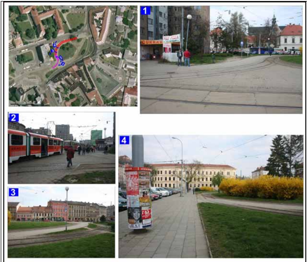
Abbildung 159: Situation und mögliche Lage von Abstellgleisen am Mendlovo náměstí. Mit lila Farbe sind benötigte neue Gleise gekennzeichnet, mit roter Farbe die erforderliche Fläche, um eine 70m lange Stadtregionalgarnitur abzustellen, mit den blauen Kamerasymbolen mit Zahl die Perspektiven der Fotos. Kartengrundlage des Orthofotos: www.mapy.cz , sonst eigene Fotos vom April 2007. Übersichtsplan aller Infrastrukturmaßnahmen für die Stadtregionalbahn siehe Abbildung 157.
